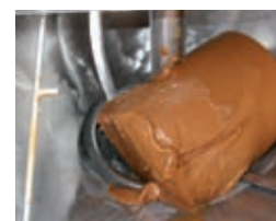
Caramel dans la trémie d'un Viscofeeder PCM
