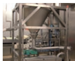
Viscofeeder PCM utilisé pour le dosage de pâte en pâtisserie industrielle
