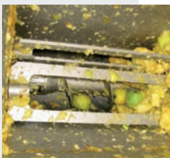
Transfert de pommes entières avec une pompe à vis de gavage pour la préparation de compote de pommes
