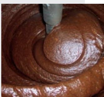
Transfert de chocolat à forte viscosité pour injection dans des desserts avec le Viscofeeder™ de PCM
