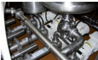
Utilisation de la pompe série H de PCM avec des produits laitiers
