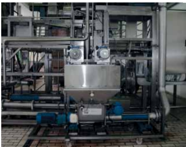
Pompe GBB inox dans l'industrie des fruits pour transfert de drêches de pommes
