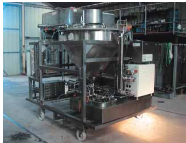
Système Viscofeeder® dans l'industrie de la crème glacée : dosage et injection d'ingrédients hyper visqueux (caramel, chocolat, préparations de fruits...)
