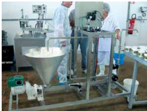
Essai de mise en route un skid de préparation et dosage de fromage en barquette.
