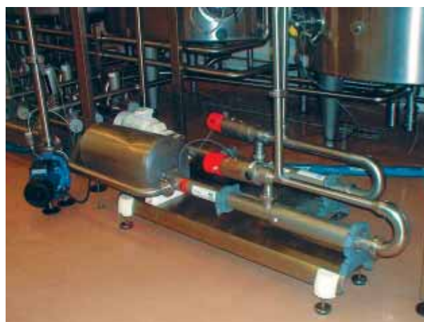
13H12 équipée d'un by-pass pour le nettoyage en place dans le secteur des produits laitiers frais pour le dosage de crème.
