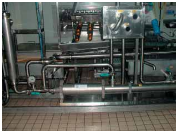
25H12 dans le secteur des ovo produits pour le transfert de coule d'oeuf liquide.
