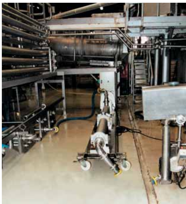
40H24 dans le secteur de transformation de fruits et légumes pour l'alimentation de purée de fruit vers un échangeur/refroidisseur
