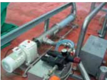
401A12 dans la fabrication de plats préparés pour transfert de sauce tomate.
