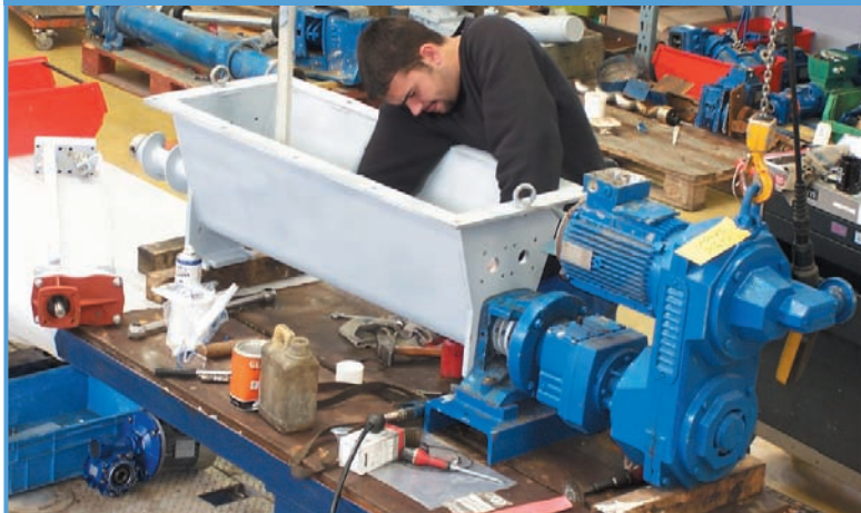
Remise en état et transformation d'une pompe Moineau de la série GBB avec montage du nouveau dévoûteur
