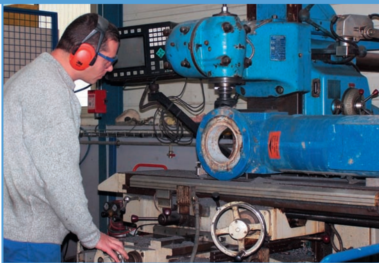
Remise en état d'une pompe avec création de portes de visite sur le corps
