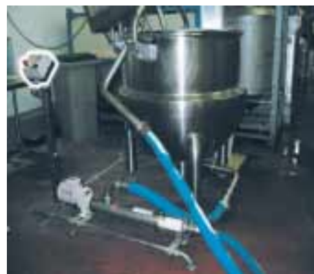
Un coffret de démarrage pour le transfert de sauces ketchup et mayonnaise.
