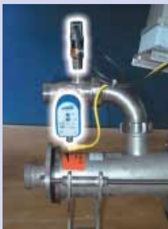
Protection contre la marche à sec sur la filtration de vin.
