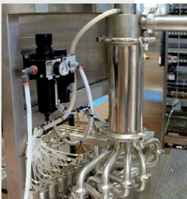
Chaque sortie du Dosymix™ alimente une buse de remplissage.
