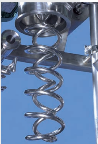
Le profil de la vis à faible cisaillement préserve la texture du produit.
