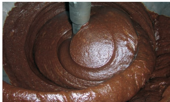
Crème glacée : les systèmes PCM permettent de transférer un chocolat à forte viscosité sans introduire de bulles d'air.
