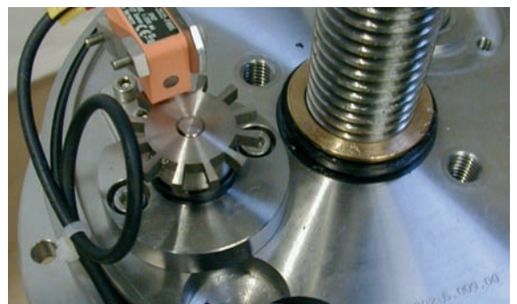
Dosage précis : la pompe doseuse à piston Dosys™ garantit une précision de +/-0,5%.
