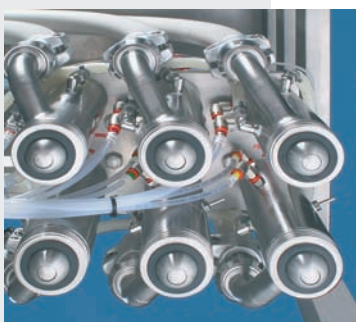
Buses spéciales conçues pour remplir les pots de yaourt avec morceaux de fruits.
